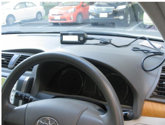
SDカード方式取付状況
